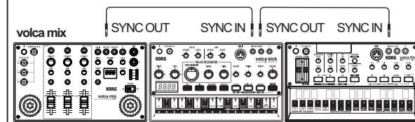
Pour démarrer simultanément les séquenceurs des volcas mis en chaîne, armez au préalable les séquenceurs en appuyant sur le bouton ▶(lecture) des volcas connectés, puis appuyez sur le bouton ▶(lecture) du volca mix.
