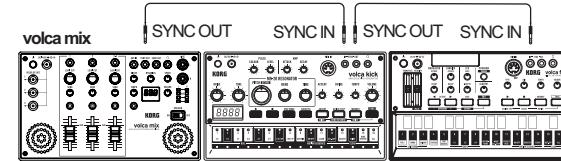
接続されたvolcaを同時に再生開始するためには、まずvolca mix以外の機器の▶(PLAY)ボタンを押しておきスタンバイ状態にします。その後にvolca mixの▶(PLAY)ボタンを押すと同時に再生が開始されます。
